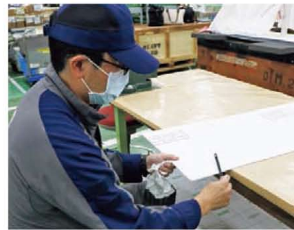
触れたときに怪我をしないよう、 断面の面取りをしています
